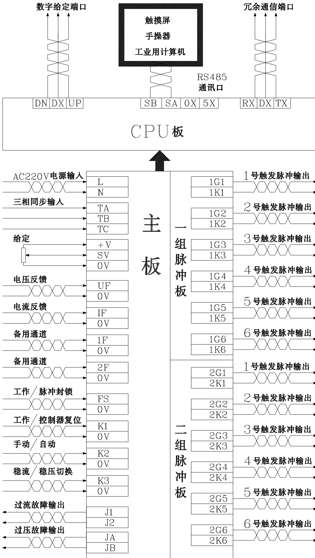
KDQ66 六脉波晶闸管数字控制器端子连线图
