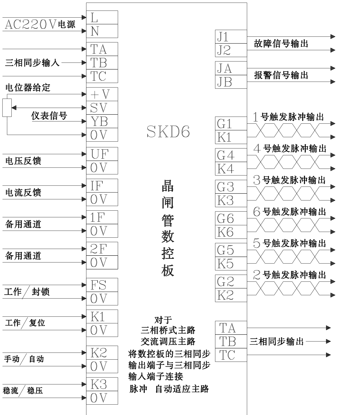
SKD6 晶闸管数控板对外连线图
